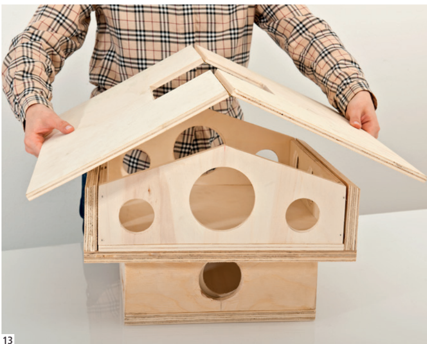
13 Das Dach aufs Obergeschoss legen. Die Futterschachtöffnung zum Aussägen auf den Boden des Einschubs zeichnen.
