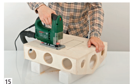
15 Öffnung aussägen und Einschub wieder einsetzen. Öffnung aufs Grundhaus übertragen und wie zuvor aussägen.
