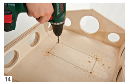
14 Vor dem Ansetzen der Stichsäge für die Futterschachtöffnung alle vier Eckpunkte durchbohren.
