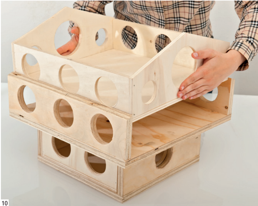
10 Das Obergeschoss inklusive oberem Einschub mit einem gleichmäßigen Überstand aufs Untergeschoss stellen.
