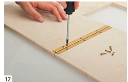
12 Stangenscharnier ablängen und die beiden Dachplatten damit verbinden.
